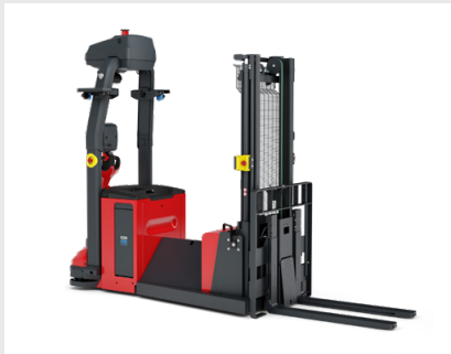
Flexibles Handling dank freitragender Gabelzinken
