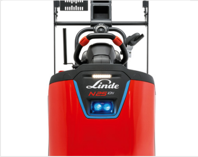
Linde BlueSpot und Front-LED-Scheinwerfer
