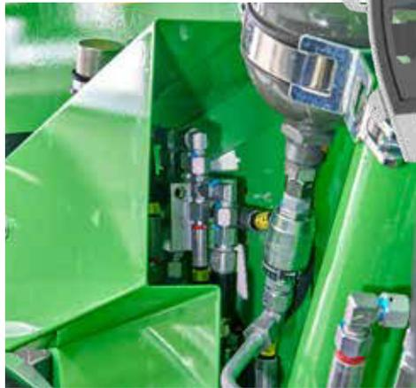
Wichtige Ventile und Elektrik sind geschützt und von außen zugänglich, selbst bei gesenktem Teleskopausleger.
