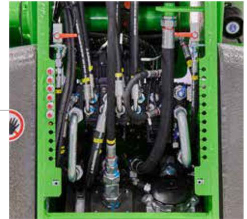
Bestmöglicher Zugang zum Hauptsteuerblock, Hydrauliköltank und Rücklaufilter.
