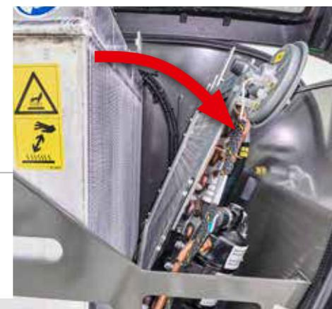
Sehr gute Zugänglichkeit zum Kühler, durch klappbaren Verflüssiger der Klimaanlage / Kraftstoffkühler.
