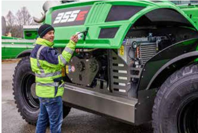
Mit einem Handgriff geräumiger Zugang zum Motorraum. Das Seitenblech der Motorgondel ist zusätzlich abnehmbar.
