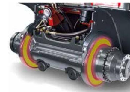
Abgekoppelte Antriebsachse H40 – H50
