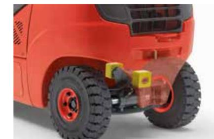
Abgekoppelte Lenkachse H25 – H35
