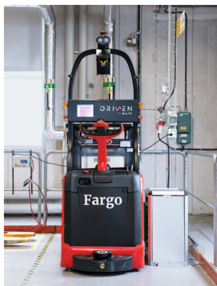
„Gofar“ und „Fargo“, so heißen die beiden automatisierten Lagertechnikgeräte, die die Teile von der Montageabteilung zum Fertigwarenlager transportieren.
